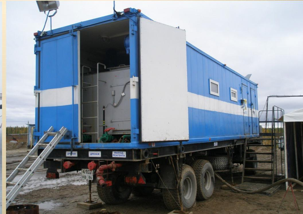
**Проведение работ по нагнетательной скважины увеличение охвата пласта изменение профиля приемистости скважины с применением полимерной технологий. (УПС + СИН-35)**
